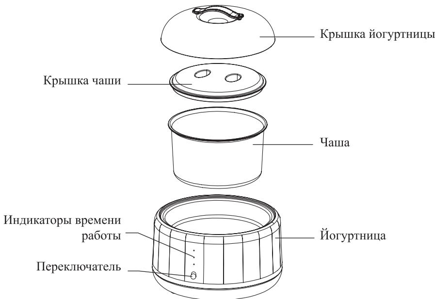
С помощью **переключателя** вы можете установить желаемое время приготовления йогурта: 8, 10 и 12 часов. При выборе времени приготовления загорается соответствующий индикатор на корпусе прибора.
