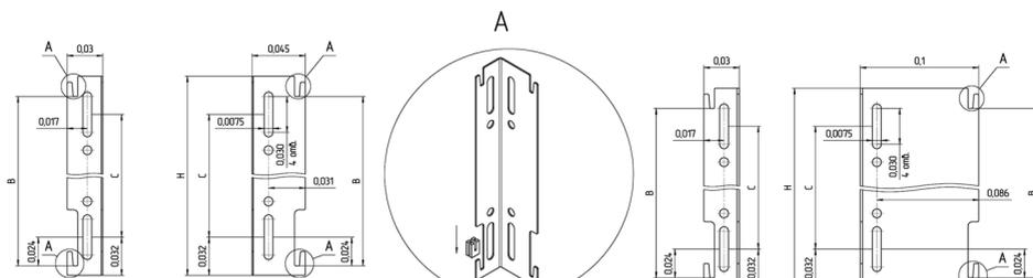
Предназначены для всех типов радиаторов с креплением Hook/Standart, кроме: CH10, CH20, CH30, VCH10, VCH20, VCH30
