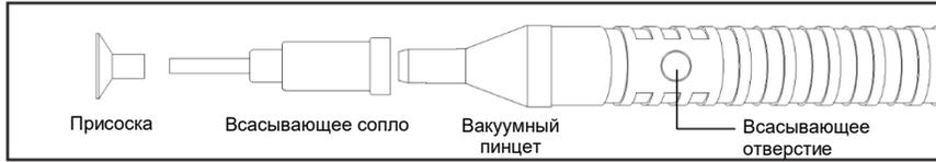
Вставьте головку всасывающего сопла в отверстие присоски и затем вставьте вакуумный пинцет с другой стороны сопла, чтобы завершить сборку.
