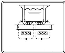
Медная катушка внутри корпуса прибора создает магнитное поле и индуцирует высокочастотный вихревой ток, который моментально нагревает стальную посуду на конфорке. При этом нагревается не плитка, а только посуда, находящаяся на ней. Направленный поток тепла к днищу посуды
