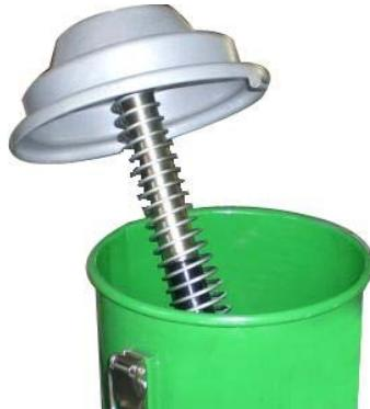
3. Максимальная емкость бака для смазки 13 кг. Заполните бак необходимым количеством густой смазки. Не допускайте образования воздушных пузырей в густой смазке при наполнении бака. Для этого надавливайте на смазку и выровняйте поверхность смазки.
