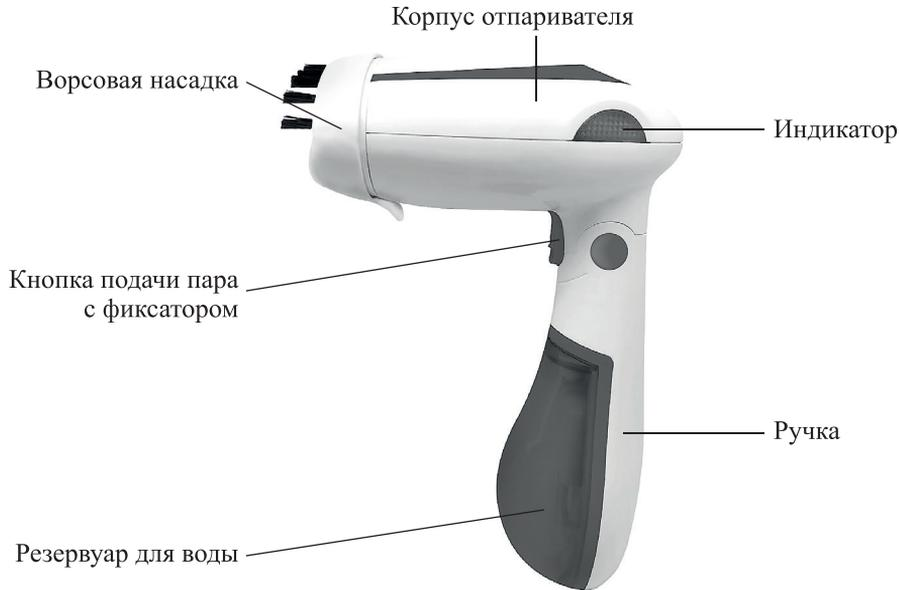
Отпариватель оснащен помпой (водяным насосом). Вода из резервуара подается помпой в бойлер, где испаряется. Пар выходит через паровые сопла на рабочей поверхности. Использование помпы позволяет точно дозировать количество подаваемой в бойлер воды и получать устойчивую подачу пара.
