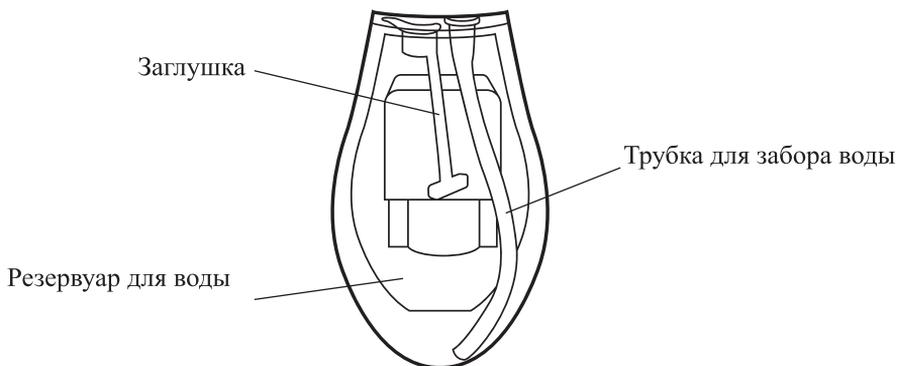
3. Залейте воду в резервуар для воды через открытое отверстие. Не заполняйте резервуар полностью, уровень воды должен быть на 1–2 см ниже края.
