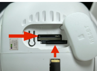
Слот MicroSD и nanoSIM Кнопка сброса
