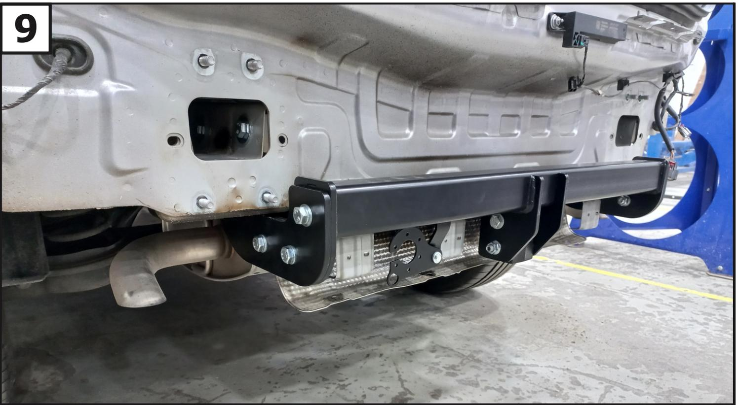
Установить балку (1), закрепив к кронштейнам болтами М12х1,25х40 (8), гайками М12х1,25 (13), шайбами 12 пружинными (17) и шайбами 12 (18). Установить кронштейн под розетку (4) с помощью болта М6х25 (7), гайки М6 (12), шайб 6 увеличенных (15) и шайб 6 полиамидных (16). Установить ответную часть быстроотъемного с помощью болта М12х1,25х100 (9), шайбы 12 с насечками (21), шпилек М12х25 (11) и М12х35 (20), гаек М12 с фланцем (14).
