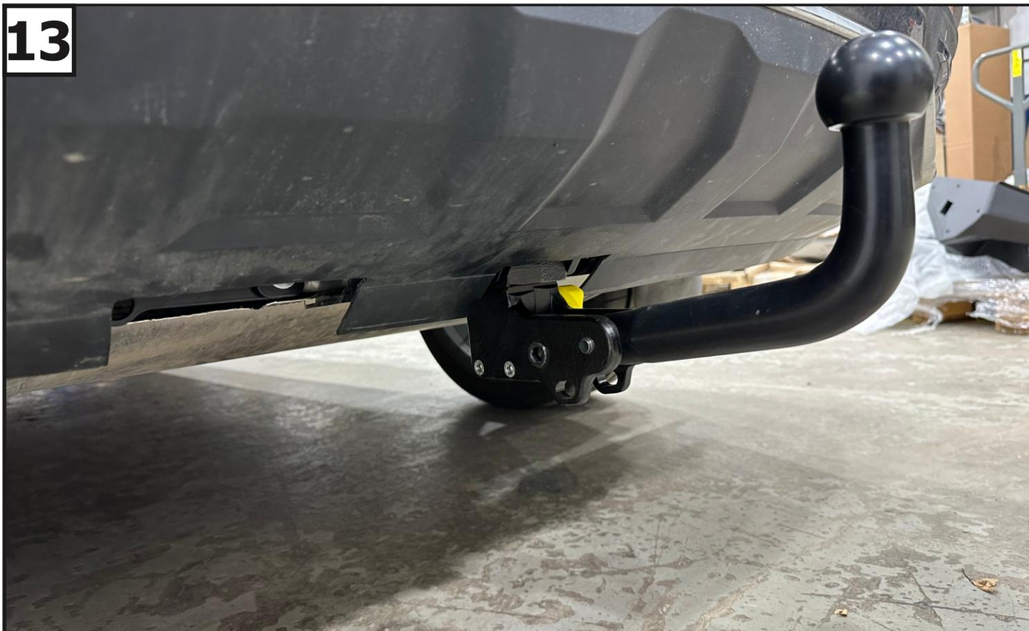
**Установить вставку быстросъема в ответную часть. Закрепить крюк с помощью винтов М12х45 (10).**
