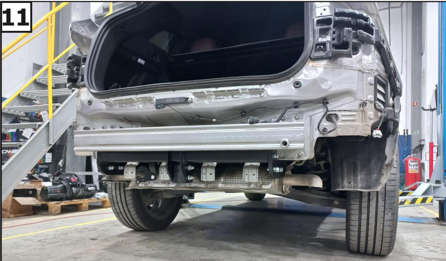
Затянуть все резьбовые соединения, сначала затянуть балку с кронштейнами, затем кронштейны к лонжеронам, после кронштейн под розетку к балке. Моменты затяжки: M6=6 Нм; M12=81 Нм. Установить усилитель бампера в обратной последовательности.
