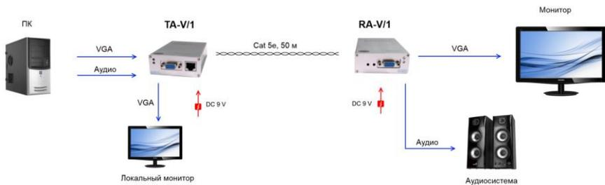
Рис.2 Схема подключения TA-V/1+RA-V/1, TA-V/2+RA-V/2, TA-V/3+RA-V/3, TA-V/4+RA-V/4, TA-V/5+RA-V/5
