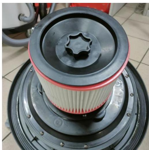
Поверните крепежную гайку по часовой стрелке и зафиксируйте крышку.
