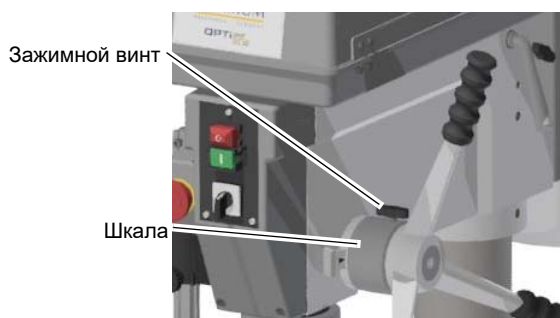
Рис. 4-2: Шкала ограничителя глубины сверления
