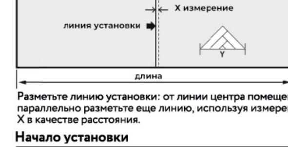
Разместите линию установки: от линии центра помещения параллельно разместите еще линию, используя измерение X в качестве расстояния.
