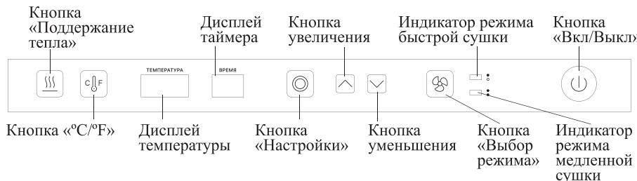
На панели управления расположены два дисплея, кнопки настройки времени и температуры, кнопка «Поддержание тепла», кнопка переключения между единицами измерения температуры °C и °F и кнопка выбора между режимами быстрой и медленной сушки.
