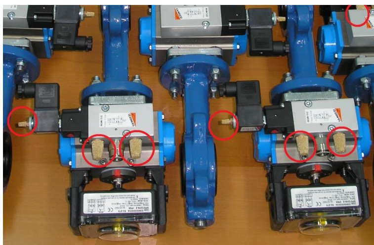
Рис.1 Способ установки глушителей на соленоидный распределитель
