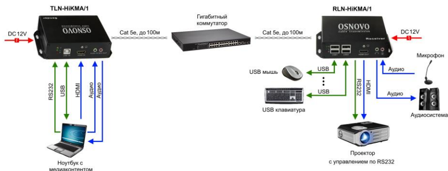
Рис.5 Схема подключения комплекта TLN-HiKMA/1+RLN-HiKMA/1 через сеть на основе гигабитного коммутатора
