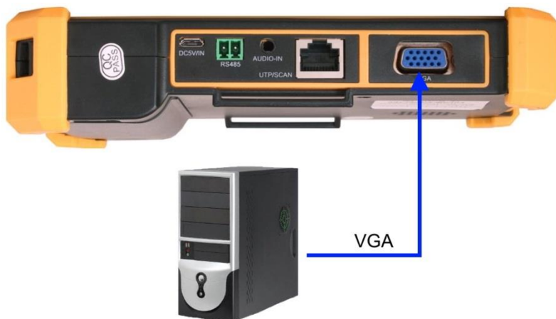
Рис.14 Подключение устройств к VGA входу тестера
