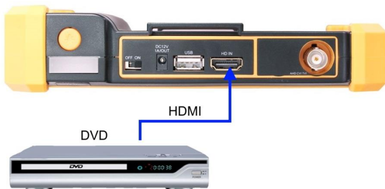
Рис.13 Подключение HDMI устройств к тестеру.
