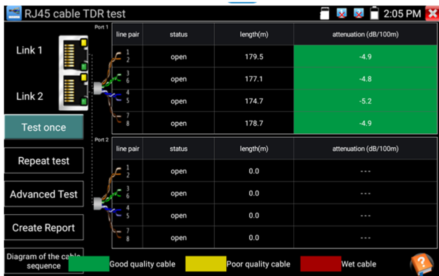
Рис. 116 Интерфейс рефлектометра (TDR) для кабеля «витой пары»
