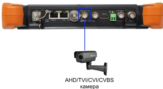
Рис. 12 Подключение AHD/TVI/CVI/CVBS видеокамеры к тестеру
