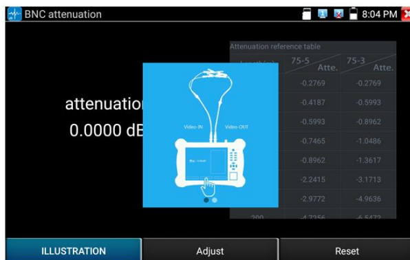
Рис. 123 Подключение кабеля для определения степени затухания
