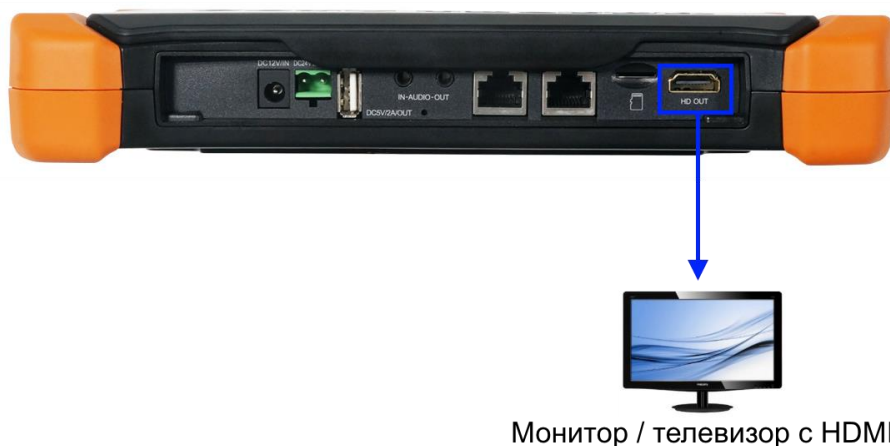
Рис. 15 Подключение тестера к HDMI-монитору
