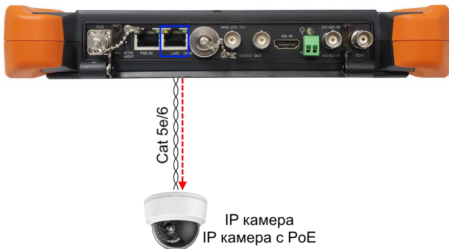
Рис. 7 Подключение IP-видеокамеры к тестеру
