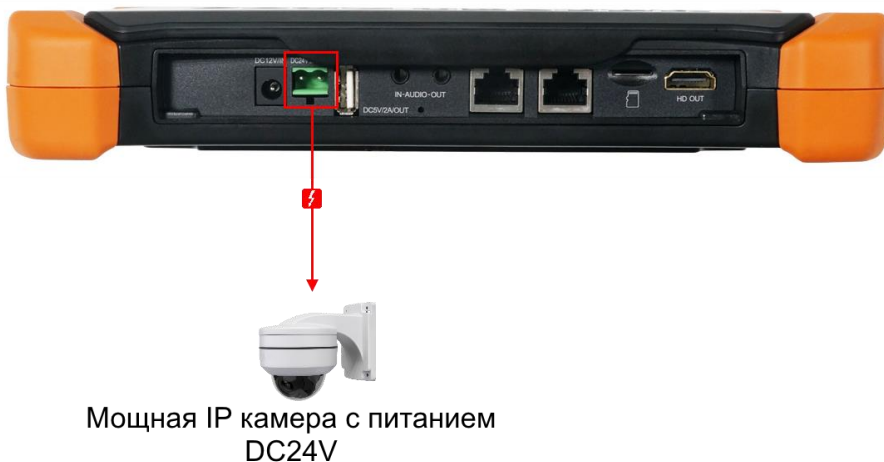
Рис. 10 Подключение питания к мощной IP-видеокамере без PoE
