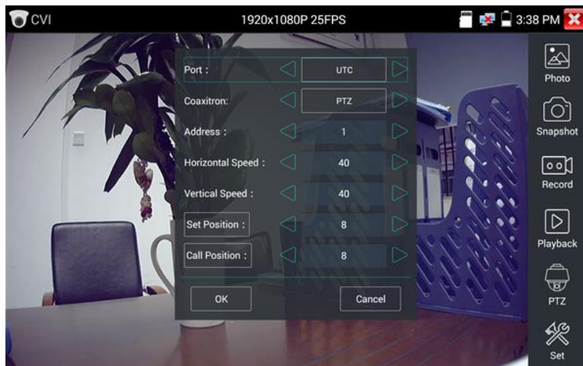
Рис. 89 Настройки для управления PTZ CVI видеокамерой по коаксиальному кабелю
