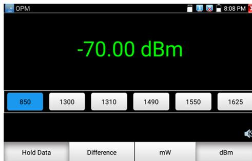
Рис. 133 Использование функции удержания последнего измерения и измерения относительной мощности
