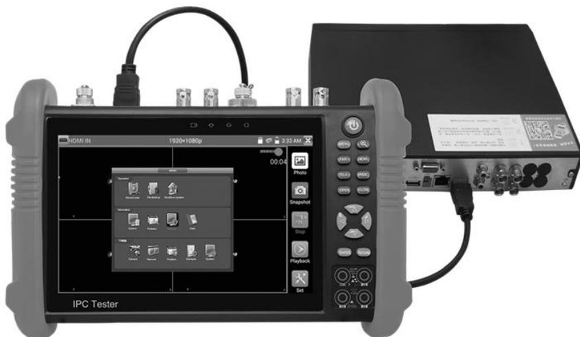
Рис. 12 Подключение HDMI устройств к тестеру.
