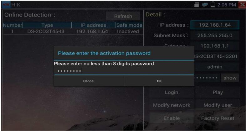
Рис. 143 Ввод пароля для активируемой видеокамеры Hikvision
