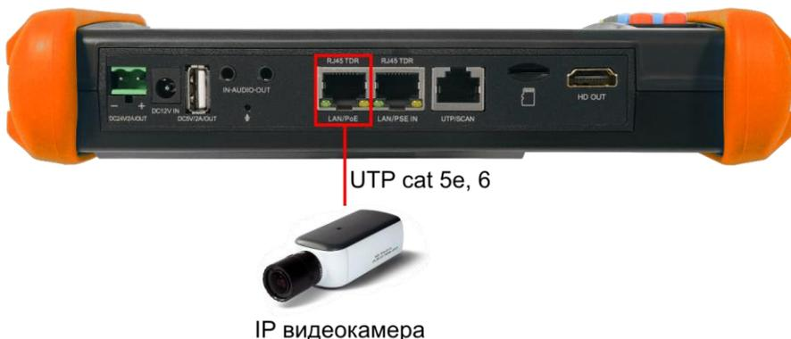
Рис. 7 Подключение IP-видеокамеры к тестеру
