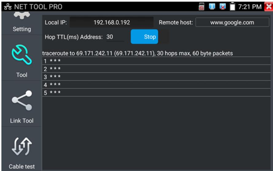
Рис. 111 Интерфейс инструмента «Трассировка маршрута» (Trace Route)
