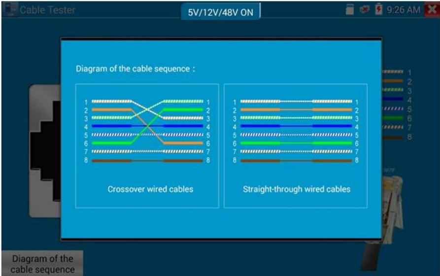
Рис. 116 Диаграммы обжимки разными методами кабеля «витой пары»
