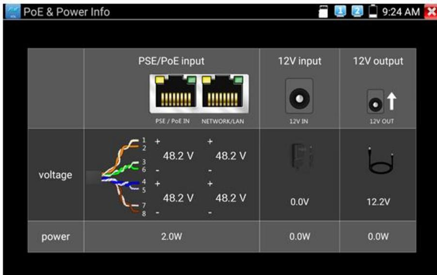
Рис. 128 Тестирование мощности и напряжения на разъеме DC12V/IN
