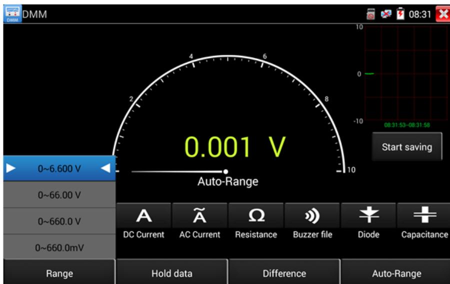
Рис. 130 Настройка ручного или автоматического диапазона измерений
