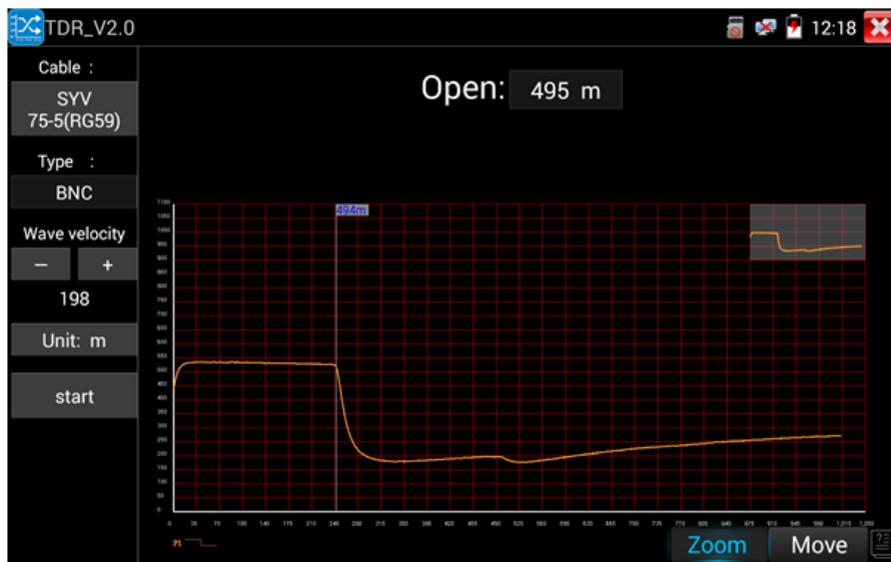
Рис. 122 Рефлектометр (TDR) для коаксиального кабеля, интерфейс
