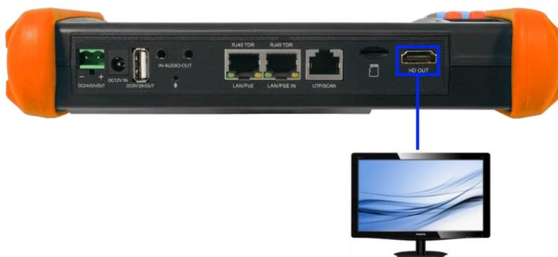
Рис. 13 Подключение тестера к HDMI-монитору
