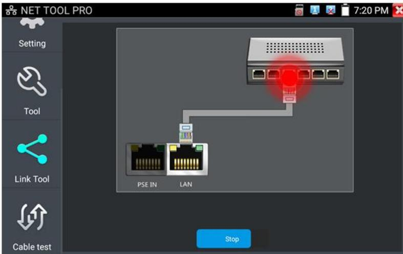
Рис. 109 Интерфейс приложения определения порта (Port Flashing)
