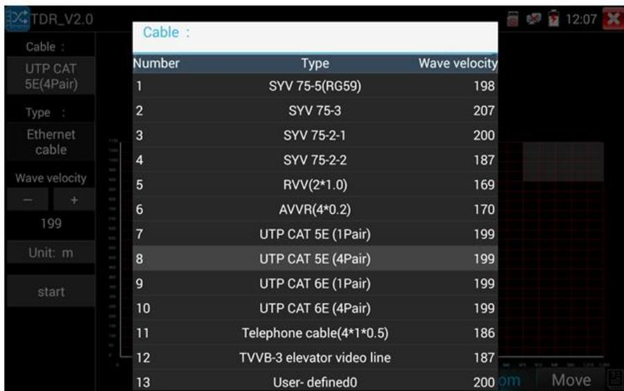
Рис. 123 Калибровка типа кабеля для TDR тестирования
