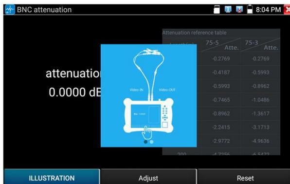
Рис. 125 Подключение кабеля для определения степени затухания
