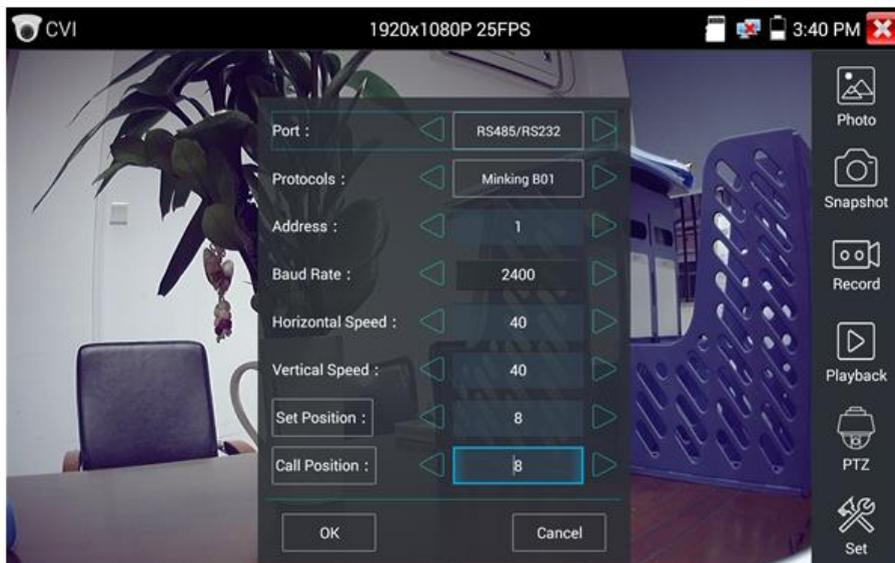
Рис.93 Управление PTZ CVI видеокамерой по интерфейсу RS232/485
