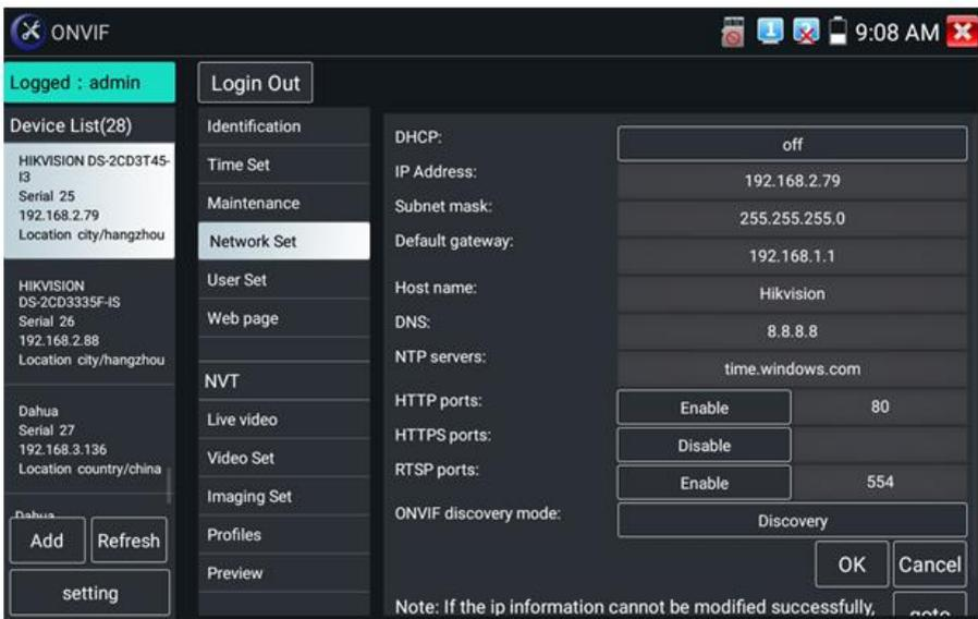
Рис. 45 Сетевые настройки IP видекамеры
