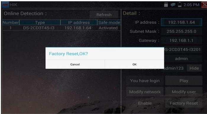
Рис. 147 Сброс видекамеры к заводским настройкам
