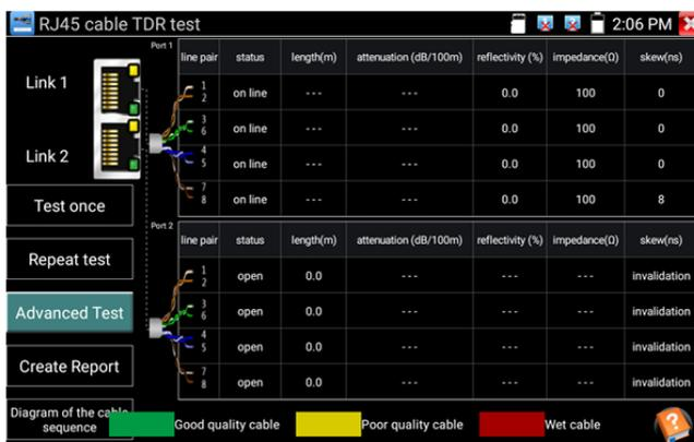
Рис. 118 Детальный тест кабеля (Advanced test)
