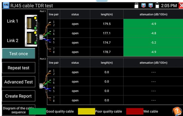
Рис. 117 Интерфейс рефлектометра (TDR) для кабеля «витой пары»
