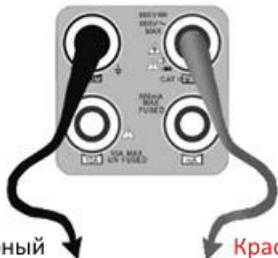
В) Выберите режим измерения емкости  $\text{C}$  на тестере
