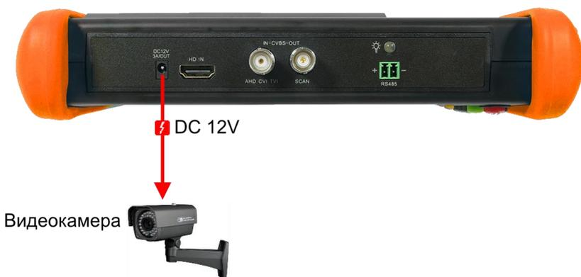
Рис. 9 Подключение питания к IP-видеокамере
