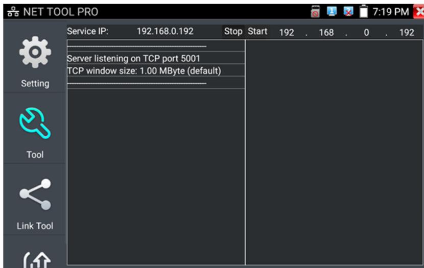
Рис. 105 Работа 1го тестера в режиме «сервер» при проверке пропускной способности сети
