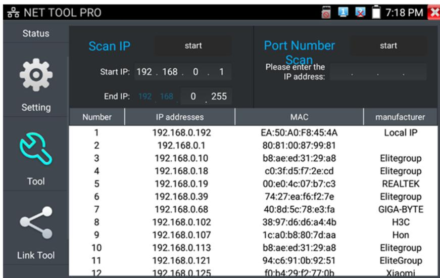
Рис. 102 Сканирование IP адресов и портов
