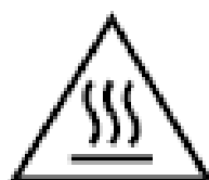
ОСТОРОЖНО: Горячая поверхность, не прикасаться!
