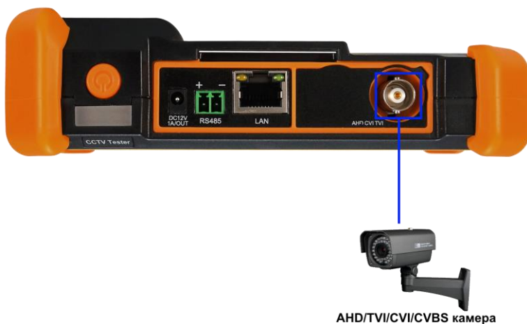
Рис. 10 Подключение AHD/TVI/CVI/CVBS видеокамеры к тестеру
