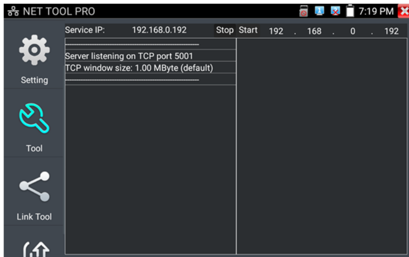
Рис. 93 Результаты тестирования пропускной способности, ПК в качестве клиента.
