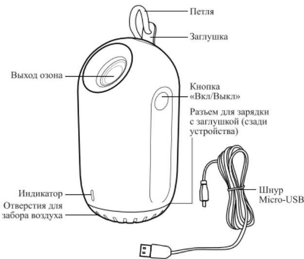
Нажав и удерживая **кнопку «Вкл/Выкл»** в течение 2 секунд, можно включить и выключить озонатор. После включения автоматически включается режим нормального озонирования.
