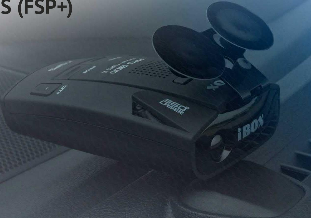
Улучшенная инновационная система защиты от помех сводит к минимуму количество ложных срабатываний от высоковольтных электрических линий, заправочных станций, шлагбаумов и других устройств, работающих в диапазонах, аналогичных диапазонам полицейских радаров.
