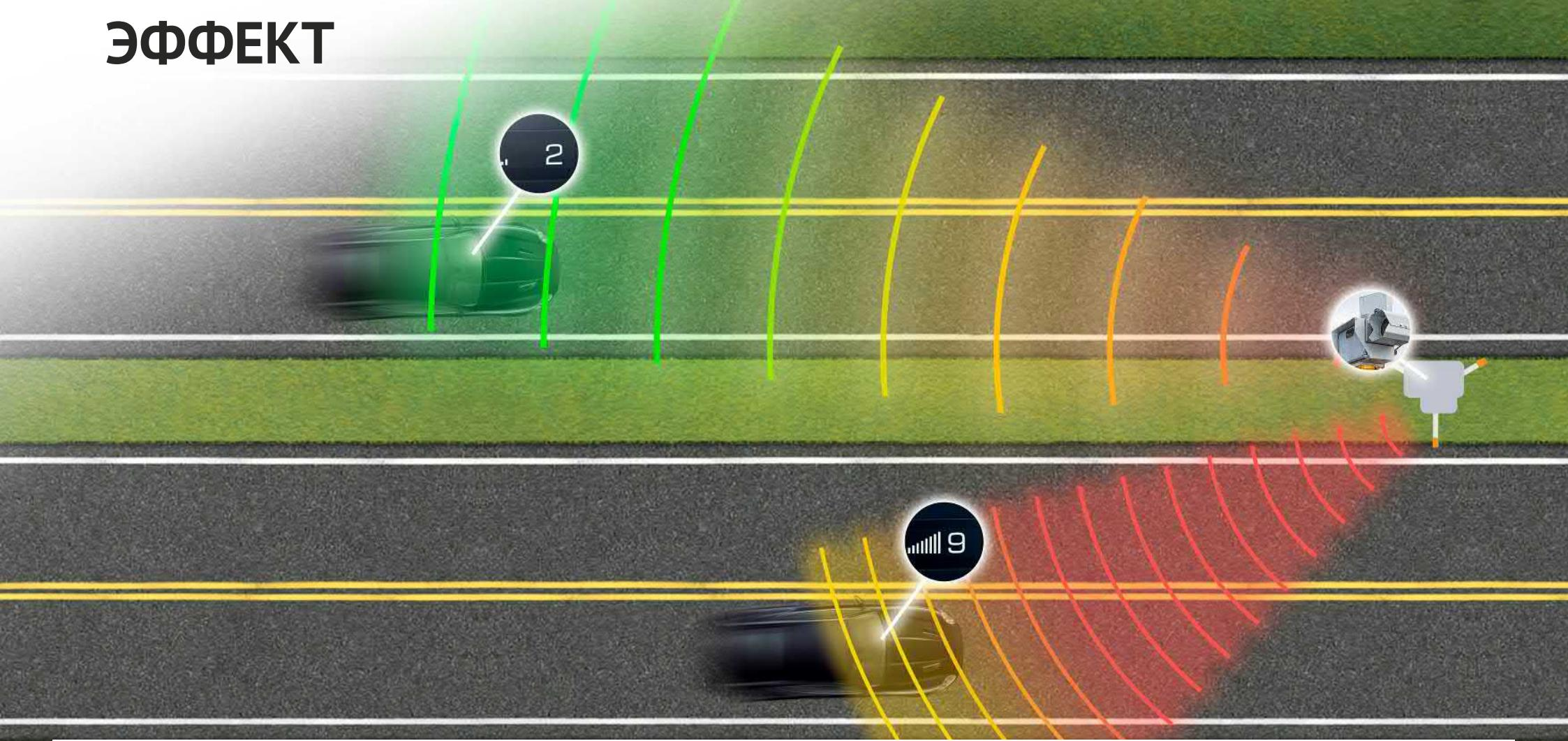
При помощи функции Гейгер-эффекта iBOX Pro 800 Signature X разделяет радиосигналы на 9 уровней интенсивности и дает графическое представление о силе излучения полицейского радара. Чем ближе радар, тем сильнее излучение и тем длиннее шкала, отображающая уровень сигнала.
