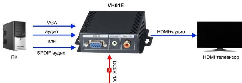
Рис.3 Типовая схема подключения преобразователя VH01E вместе с ПК
