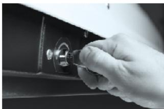
8 Для закрытия автобокса плотно закройте крышку, убедитесь что петли замков заведены в посадочные места механизма запирания, поверните ключ по часовой стрелке.
