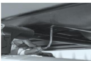
2 Вставьте скобы крепления снизу через поперечины в технологические отверстия днища автобокса.
