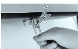
10 Застегните 2 регулируемых натяжных замка в носовой и задней части автобокса.
