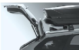
4 Выровняйте автобокс относительно центральной оси автомобиля. Установите болты, чтобы открытая дверь багажного отделения не упиралась в него.
