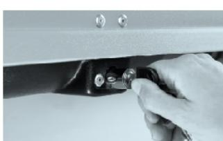
9 Для закрытия автобокса плотно закройте крышки и нажмите на кнопку замка.
