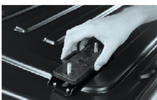
3 Придерживая скобы изнутри автобокса, установите проставки усиителя и нажмите гайки «барашек».
