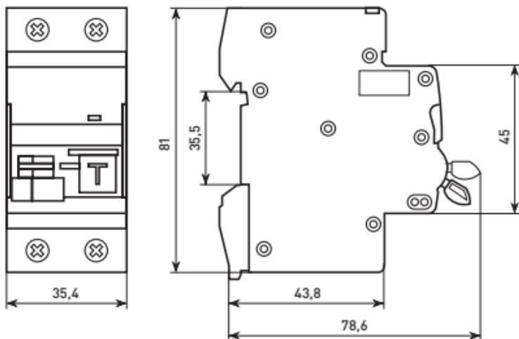
Рис. 3 - Габаритные размеры
