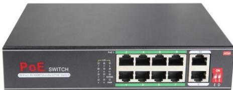
PoE коммутатор с функцией антизависания для CCTV предназначен для коммутации IP-устройств по проводной сети. Коммутатор оснащен восемью LAN-портами с поддержкой питания PoE-устройств до 30Вт на порт и двумя LAN-портами без PoE. Суммарное PoE питание до 110Вт. Управление коммутатором осуществляется DIP-переключателями для изменения длины линии до 250м и работы VLAN, перезапуска PoE-портов.
