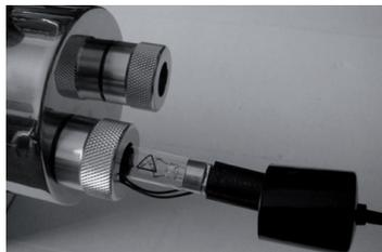
11: Плотно оденьте изолирующую крышку на открытую гайку.
