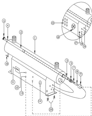
1. Камера реактора
