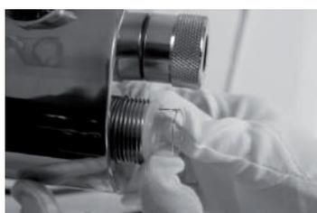
6: Установите уплотнительное кольцо на закрытый конец кварцевой гильзы, прижав к камере реактора.
