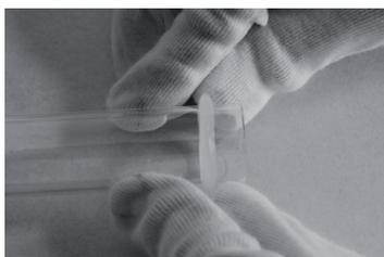
5: Установите кварцевую гильзу в камеру реактора.
