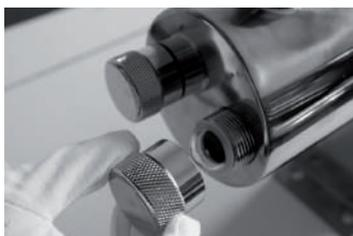
8: Накрутите открытую гайку на корпус реактора (открытый конец кварцевой гильзы). Не затягивайте слишком сильно, что бы не повредить уплотнительное кольцо. Проверьте на отсутствие протечек.
