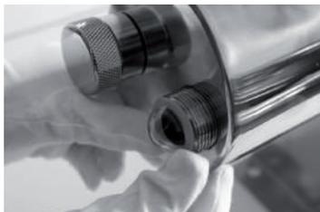
7: Накрутите закрытую гайку на корпус реактора (закрытый конец кварцевой гильзы). Не затягивайте слишком сильно, что бы не повредить уплотнительное кольцо.
