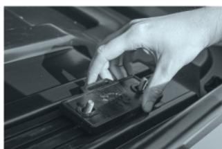
3 Придерживая скобы внутри автобокса, установите проставки усилителя и наживите гайки «барашек».
