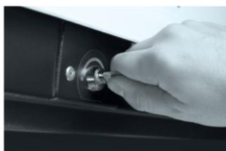
7 Для открытия автобокса вставьте ключ в личинку замка и поверните против часовой стрелки (при открытом автобоксе ключ остаётся в замке).
