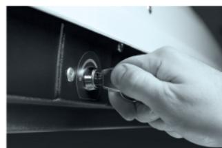
8 Для закрытия автобокса плотно закройте крышку, убедитесь что петли замков заведены в посадочные места механизма запираения, поверните ключ по часовой стрелке.
