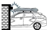
При заезде в гараж, крытый автопаркинг и пр., убедитесь, что высота автомобиля с автобоксом не превышает высоту въезда
