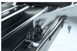
5 Затяните гайки «барашек» усилием пальцев, не используя при этом плоскогубцы или любые другие инструменты\*!!!.
