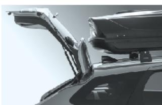
4 Выровняйте автобокс относительно центральной оси автомобиля. Установите автобокс так, чтобы открытая дверь багажного отделения не упиралась в него.
