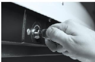
8 Для закрытия автобокса плотно закройте крышку, убедитесь что петли замков заведены в посадочные места механизма запирания, поверните ключ по часовой стрелке.
