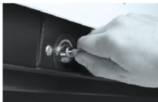
7 Для открытия автобокса вставьте ключ в личинку замка и поверните против часовой стрелки (при открытом автобоксе ключ остаётся в замке).
