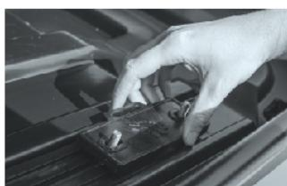
3 Придерживая скобы изнутри автобокса, установите проставки усилителя и наживите гайки «баращек».
