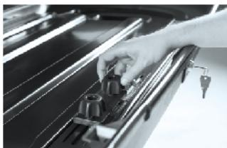
5 Затяните гайки «баращек» усилием пальцев, не используя при этом плоскогубцы или любые другие инструменты\*!!!.
