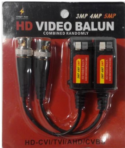
**Назначение :** Передатчик 1 канала аналогового HD сигнала до 5Мп формата по витой паре UTP категории 5е/6. Передача сигнала AHD/CVI/TVI/CVBS. Тип пассивный. Вес 80г. Материал пластик.
