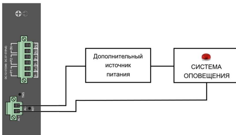
Рис.9 Схема подключения системы оповещения к коммутаторам SW-80402/ILS(port 90W 180W) и SW-80802/ILS(port 90W 300W)
