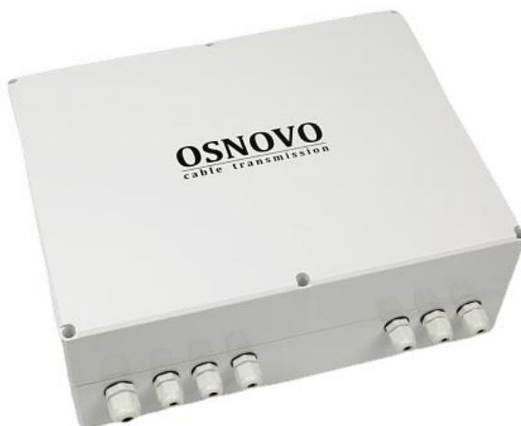
Рис.1 Коммутатор SW-80402-W(port 60W), вид снаружи
