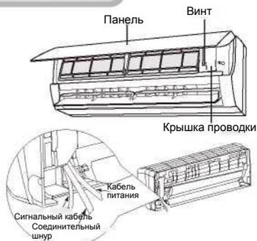
3. Снимите хомут для провода; подсоедините соединительный шнур к клемме согласно электромонтажной схеме; затяните винт, а затем закрепите соединительный шнур с помощью хомута.
