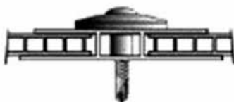
Рисунок 4 – Правильное крепление поликарбоната
