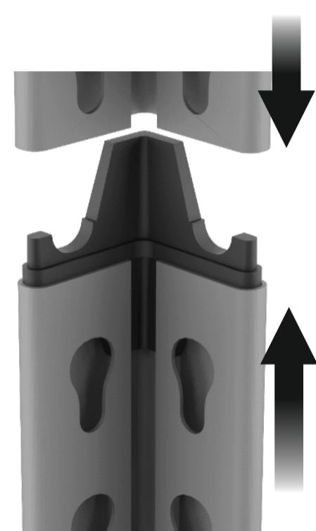
2. Установить пластиковый фиксатор и соединить стойки.
