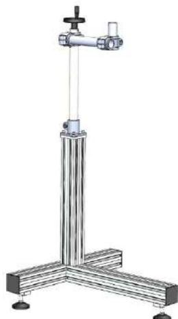
Стойка с основанием «Т» шириной 700 и глубиной 680 мм изготавливается из анодированного алюминия, нержавеющей стали и пластика позволяя устанавливать оборудование в помещениях любой влажности. Основание стойки имеет регулируемые опоры или колеса с блокировкой, с помощью которых стойку можно легко перемещать и жестко фиксировать в месте установки. Ходовой винт вертикальной регулировки с трапецидальной резьбой позволяет легко изменять положение аппликатора.
