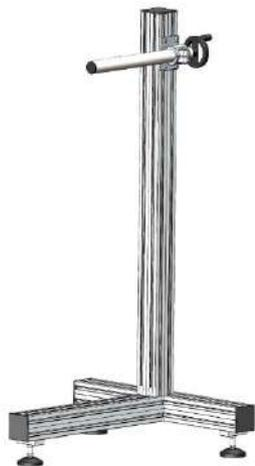
Стойка с основанием «Т» шириной 700 и глубиной 680 мм изготавливается из анодированного алюминия, нержавеющей стали и пластика позволяя устанавливать оборудование в помещениях любой влажности. Основание стойки имеет регулируемые опоры или колеса с блокировкой, с помощью которых стойку можно легко перемещать и жестко фиксировать в месте установки. Ходовой винт горизонтальной регулировки с трапецидальной резьбой позволяет изменять положение аппликатора без чрезмерных усилий.
