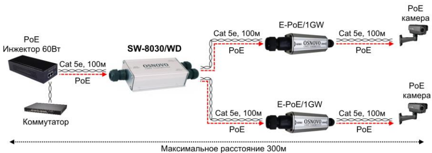
Рис.4 Схема подключения коммутатора/удлинителя SW-8030/WD вместе с удлинителем E-PoE/1GW (приобретаются отдельно).
