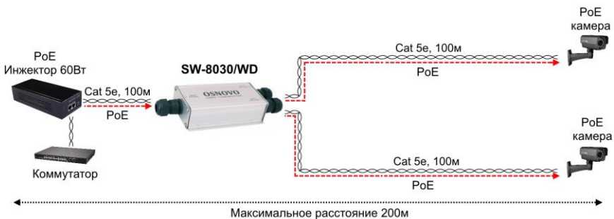
Рис.3 Типовая схема подключения коммутатора/удлинителя SW-8030/WD
