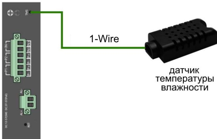
Рис.12 Схема подключения внешнего датчика температуры и влажности
