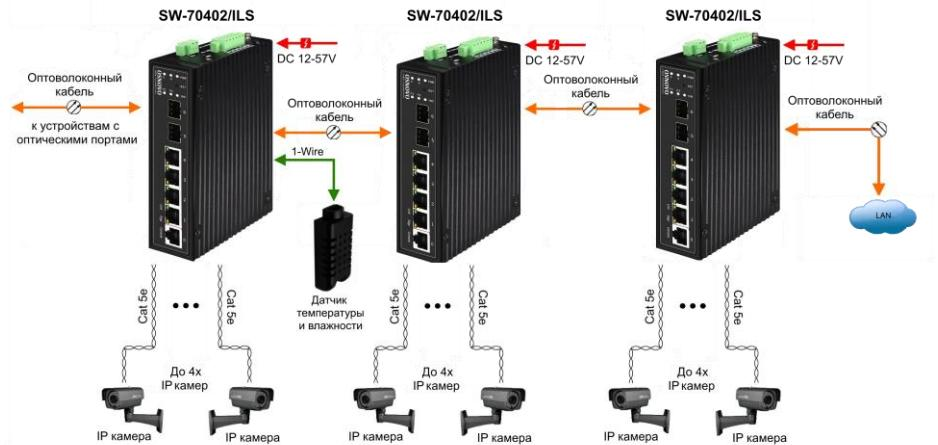
Рис.11 Схема подключения коммутатора каскадом, на примере SW-70402/ILS
