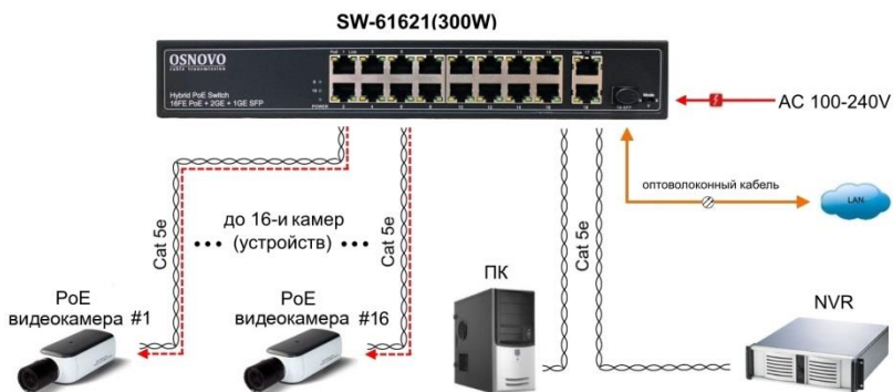
Рис.4 Типовая схема подключения коммутатора SW-61621(300W)
