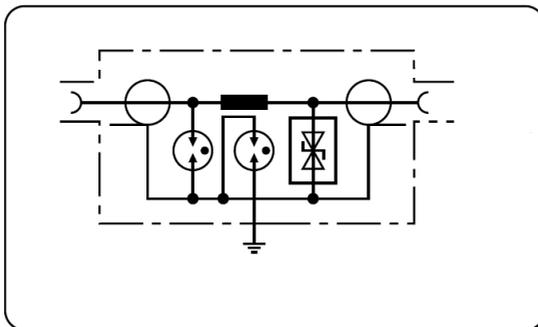
Рис.7 Принципиальная электрическая схема устройств грозозащиты SP-NC, SP-H16C
