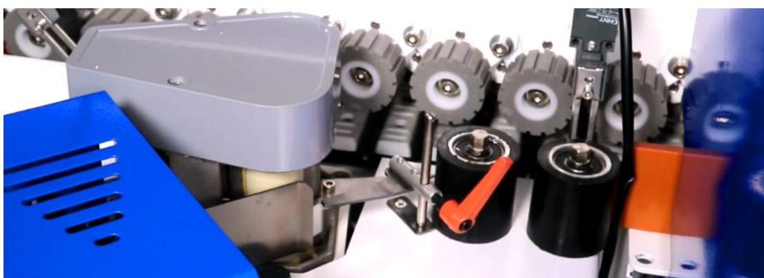
5.12. Узел прифуговки состоит из 2х прижимных роликов для обеспечения равномерного склеивания.
