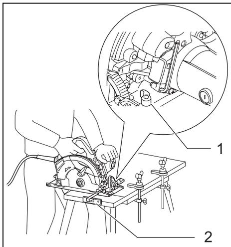
► 1. Рычаг зажима 2. Направляющая планка (направляющая линейка)
