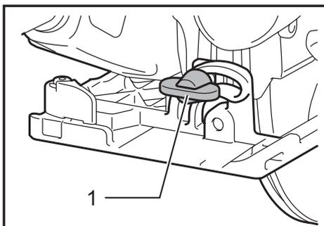
► 1. Задняя крыльчатая гайка
