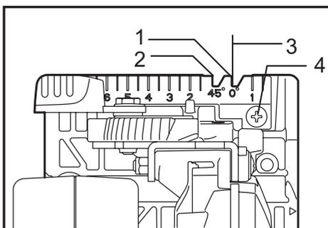
► 1. Положение  $0^{\circ}$  2. Положение  $45^{\circ}$  3. Линия отреза 4. Винт
