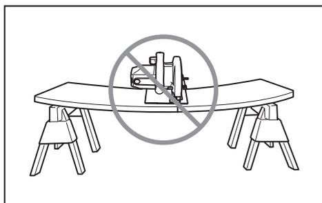
5. Не используйте тупые или поврежденные диски. Незаточенные или неправильно установленные диски приведут к узкому распилу, что вызовет чрезмерное трение, заклинивание диска и отдачу.
