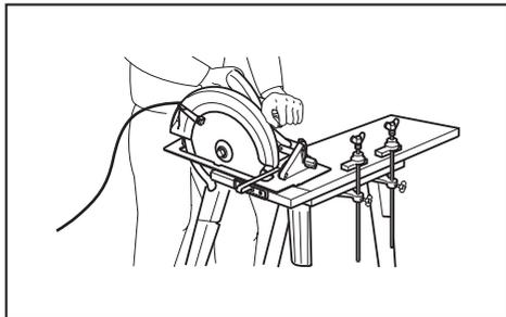
5. Если при выполнении работ существует риск контакта режущего инструмента со скрытой электропроводкой или собственным шнуром питания, держите электроинструмент за специально предназначенные изолированные поверхности. Контакт с проводом под напряжением приведет к тому, что металлические детали инструмента также будут под напряжением, что приведет к поражению оператора электрическим током.
