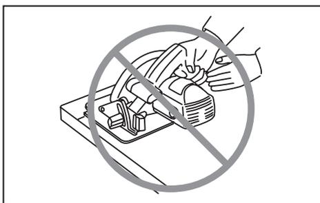
9. **Никогда не прилагайте повышенных усилий к пиле. Двигайте пилу вперед со скоростью, которая позволяет дисковой пиле пилить без снижения скорости.** Приложение повышенных усилий к дисковой пиле может привести к неравномерному распилу, снижению точности и возможной отдаче.
