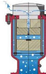
Выпуск небольших объемов воздуха. В ходе эксплуатации трубопровода выпуск воздуха осуществляется через малое поперечное сечение.
