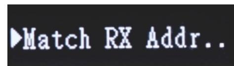
Только когда MDP-M01 сопряжен с MDP-P906, может быть активирована функция автоматического сопоставления беспроводных адресов. Способ сопоставления см. в разделе “4. Интерфейс CONFIG” в «MDP-M01 Умный цифровой дисплей Инструкция». При сопоставлении беспроводных адресов, если выходная мощность включена, из соображений безопасности выходная мощность будет принудительно отключена.
