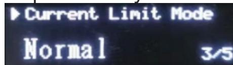
**Применимые условия:** когда выходной ток установлен на 10 А, а источник питания по-прежнему не может справиться с нагрузкой для нормального запуска, вы можете попробовать использовать «неограниченный» мощный режим.
