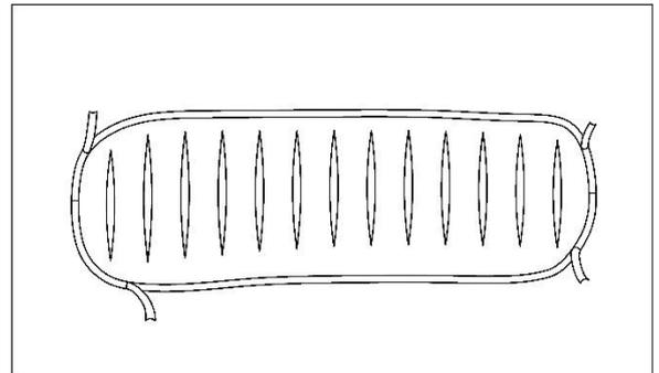
**Шаг 2.** Перед установкой деталей на автомобиль, отогните концы защитной пленки двухстороннего скотча на 3-4 см.
