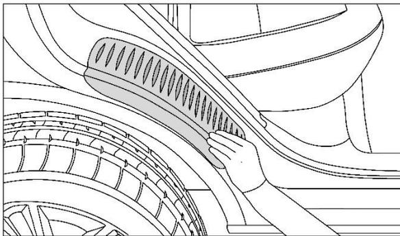
**Шаг 5.** Плотно прижмите установленную накладку по периметру её прилегания.
