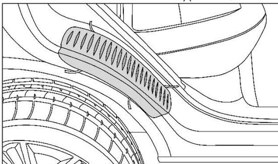
**Шаг 3.** Приложите накладку к поверхности автомобиля. Определить место установки детали по совпадению геометрии.
