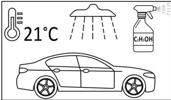
Перед установкой накладок вымойте и высушите автомобиль. Обработайте кузов автомобиля в местах контакта с двухсторонним скотчем любым обезжиривателем, подходящий к вашему ЛКП.
