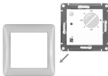
6.2 Подключить провода питания, нагревательную секцию или нагревательный прибор (нагрузку) и выносной датчик температуры к терморегулятору. При соединяемые провода должны иметь сечение 0.75–2.5 мм<sup>2</sup> в зависимости от мощности нагревательных приборов. **Нагрузка мощностью более 3500 Вт подключается через магнитный пускатель.**
