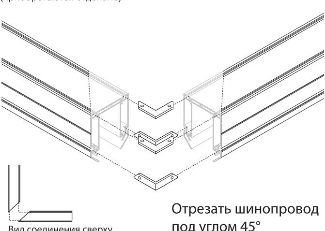
Отрезать шинопровод под углом 45°
