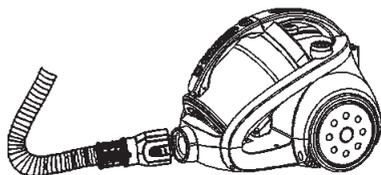
1. Выровняйте гибкий шланг относительно воздухозаборного отверстия на корпусе пылесоса, а затем прижмите до фиксации.
