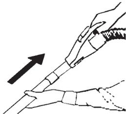
2. Соедините телескопическую трубку с ручкой гибкого шланга.
